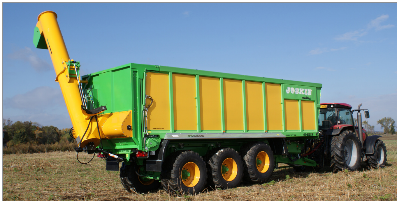
DRAKKAR с перегрузочным шнеком и динамической системой взвешивания, позволяющей контролировать массу груза в соответствии с регламентом.
